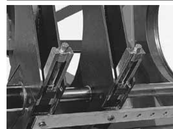
Перемычка, соединяющая 3 зажим с соседним
