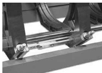
Перемычка, соедин. 3 зажим с соседним
