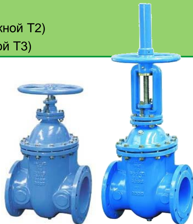
Задвижка с овальным клином - KOS ДУ 50...1200 / РУ 16 / 10 Строительная длина EN 558-1, GR 15 (ранее DIN 3202, F5)
